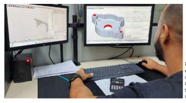
Programmazione efficiente: in Sintercan i programmatori CAM utilizzano la tecnologia feature e macro di *hyper*MILL.
