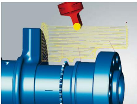
**황삭:** 황삭 과정에서 동시 B축 사용이 포함된다. 혁신적인 접근법은 공구 활용도 최적화, 공구 수명 연장과 같은 여러 이점을 제공합니다.
