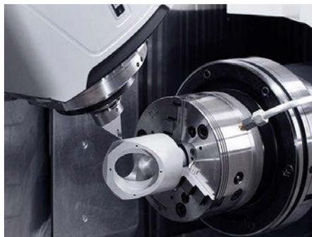
Usinagem completa em uma máquina de torneamento-fresamento CTX da DMG MORI
