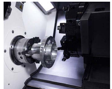
在配备西门子控制器的 DMG MORI CTX alpha 500 上进行转塔车削
