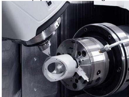
Mecanizado completo en una máquina de fresa-torno de DMG MORI, tipo CTX
