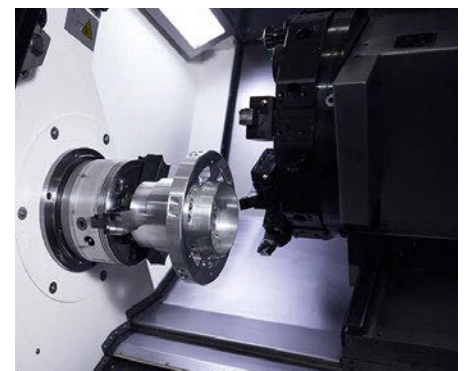
Torno con equipo de revólver en una CTX Alpha 500 de DMG MORI con control Siemens
