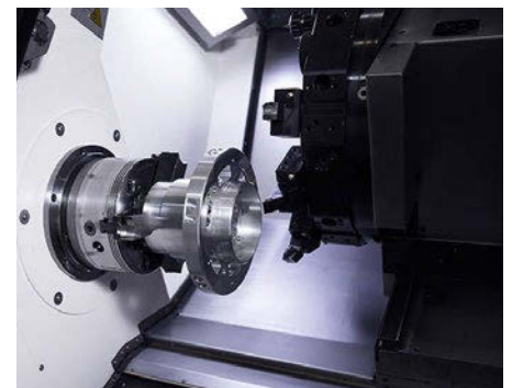
Tournage avec équipement de tourelle sur une CTX alpha 500 de DMG MORI avec commande Siemens
