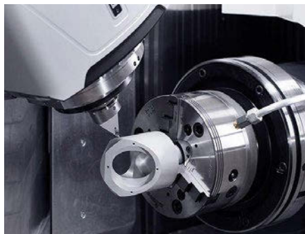
Usinage complet sur une machine de tournage-fraisage de DMG MORI de type CTX
