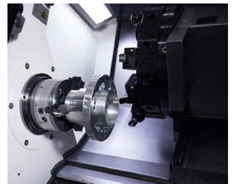
Tornitura con attrezzaggio a torretta su CTX alpha 500 di DMG MORI con sistema di controllo Siemens
