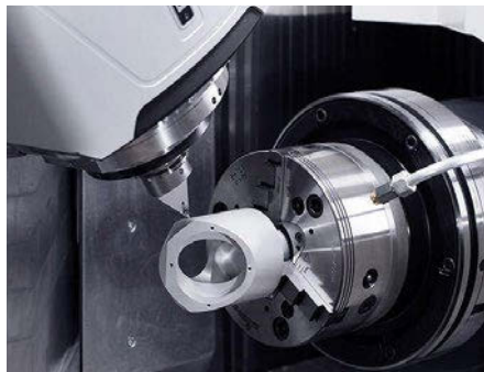
Lavorazione completa su una macchina per tornitura-fresatura di DMG MORI tipo CTX
