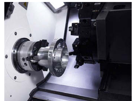
Draaien met de revolverconfiguratie op een CTX alpha 500 van DMG MORI met een Siemens-besturingssysteem
