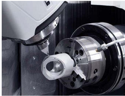
Alles-in-één bewerking op een draai-freesmachine type CTX van DMG MORI
