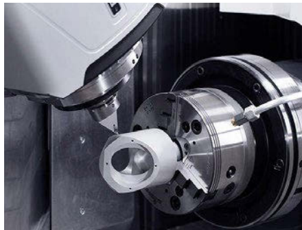
Комплексная обработка на токарно-фрезерном станке DMG MORI типа CTX
